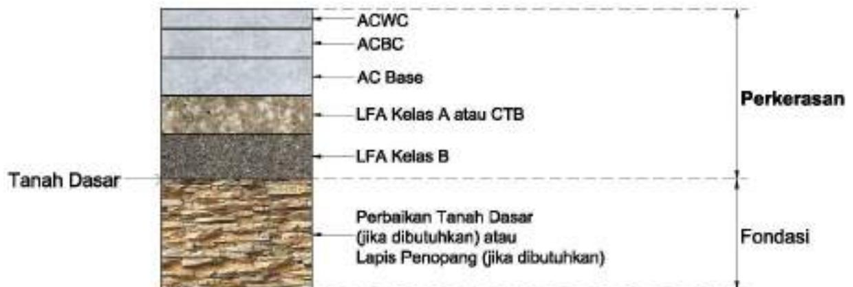
**Gambar 1.1. Tipikal Struktur Perkerasan Lentur.**
