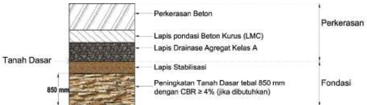
Gambar 1.2. Tipikal Struktur Perkerasan Kaku.
