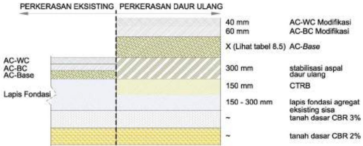
Tipikal tanah asli di bawah perkerasan eksisting pada area timbunan rendah di atas tanah lunak – Untuk kondisi lainnya dibutuhkan desain mekanistik.
